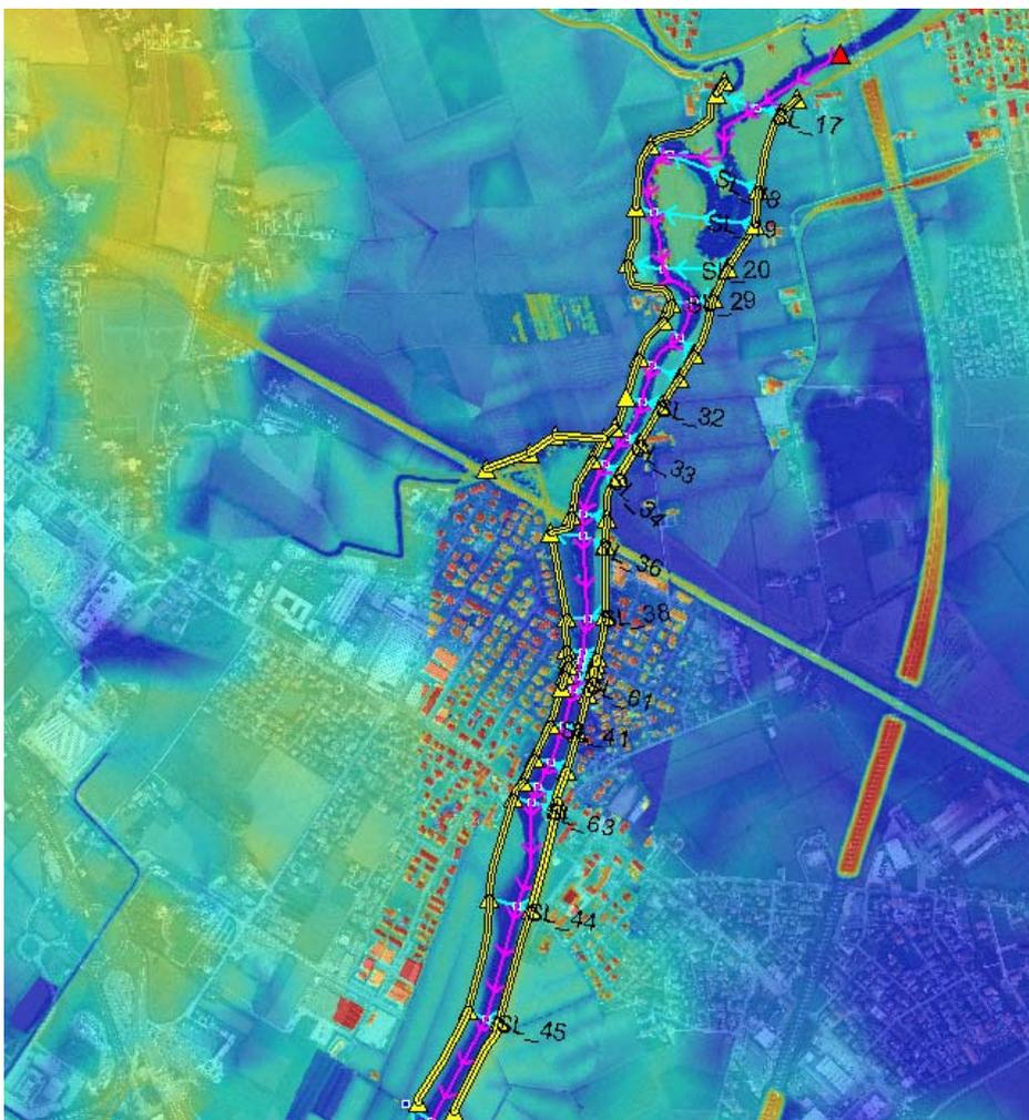
Implementazione del modello mono-bidimensionale TUFLOW – in giallo sono evidenziate le breaklines delle arginature
